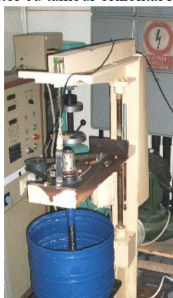
Stand pentru studiul procesului de amestecare a amestecurilor nenenewtoniene
