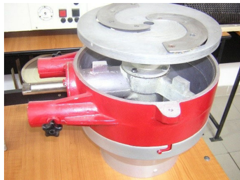
Mașina de tăiat cu disc orizontal. Partea activă a grupului de lucru
