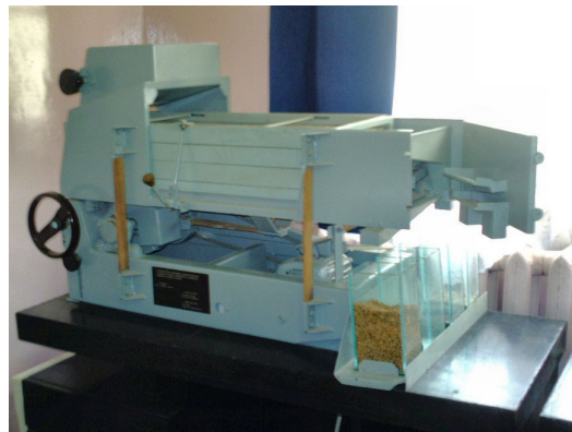
. Stand pentru separarea particulelor solide pe site plane oscilante
